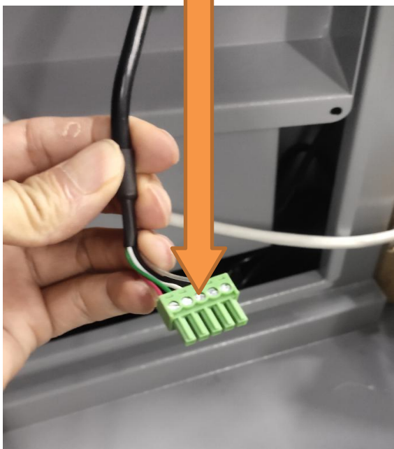
体重秤接线端子
